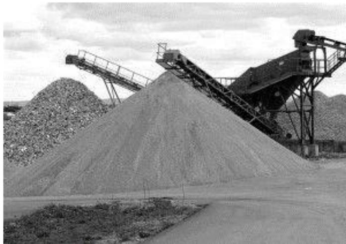
**Imagen 7.** *Planta de trituración de escombros.* (RECYTRANS,2011)
